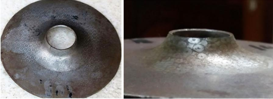
Figura 75 - Dimensões da malha antes e após a deformação. À direita elipse resultante da deformação. Fonte: O autor.
