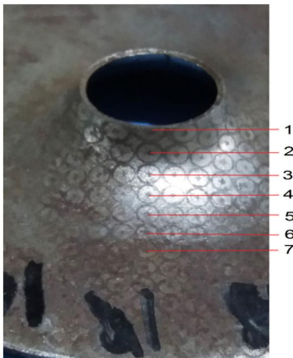
A Tabela 16 apresenta as medidas dos comprimentos maior e menor das elipses e o valor correspondente da deformação verdadeira do material naqueles pontos. A chapa com furo cônico apresenta o diâmetro do furo expandido de 15,4 mm e a chapa com furo cônico possui o furo expandido de 15,7 mm de diâmetro.
