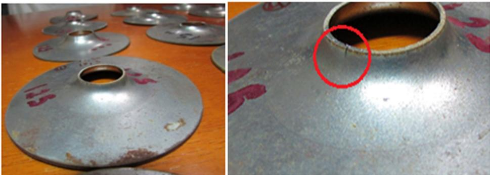
Figura 46 - Deslocamento excessivo do punção, ocasionando um rompimento excessivo nas bordas do furo. Este ensaio deve ser descartado. Trinca muito grande.
