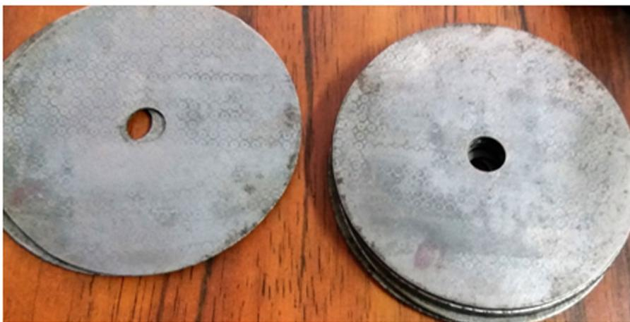
A Figura 74 mostra uma chapa com a malha para o exame da visioplaticidade após a expansão do furo. Num ensaio de expansão de furos a região de maior interesse é a borda do furo. A borda do furo é o local que apresenta as maiores deformações, como pode ser observado no detalhe da Figura 74.
