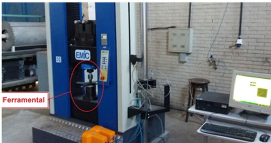
A figura apresenta em maiores detalhes o ferramental utilizado para o ensaio, á montado na máquina de ensaios EMIC.
